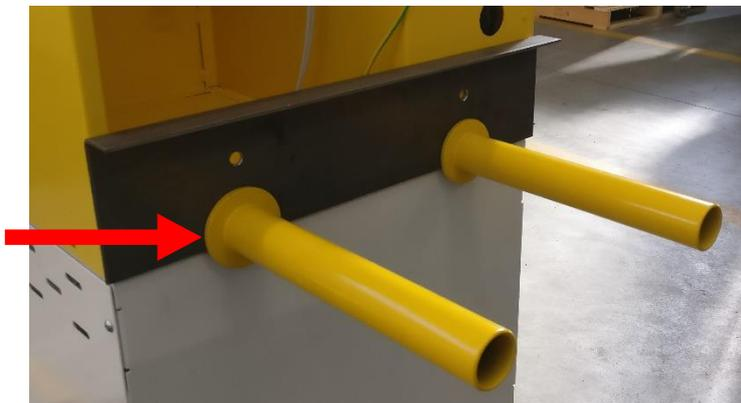
Figura 6 - Maniglie e piastra di movimentazione manuale posteriori
