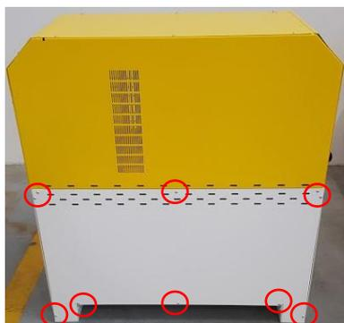
Figura 2 – Rimozione viti pannello
