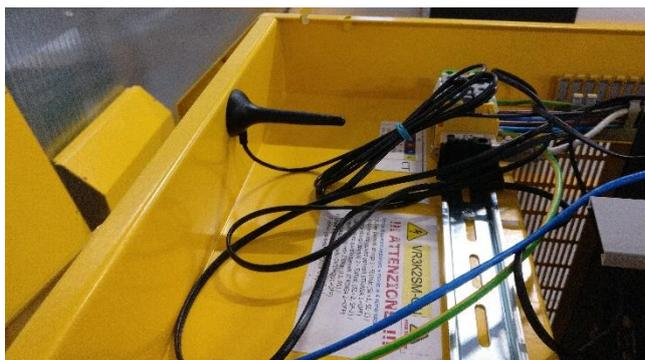
Figura 9 – Antenna GPRS posizione iniziale
